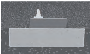
LED電極部の金ワイヤー・ボンディング断面 (SEM像)
