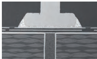
ピンがハンダ付けされたプリント基板の断面 (SEM像)
